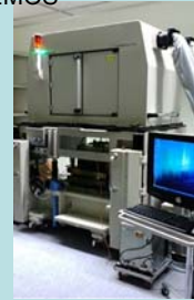
チップセキュリティ実験のための 収束イオンビーム加工機 FIB
